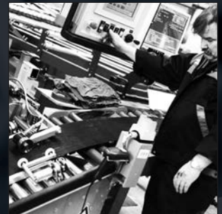
KASAUS Uusi kulutuspinta liitetään runkoon.
