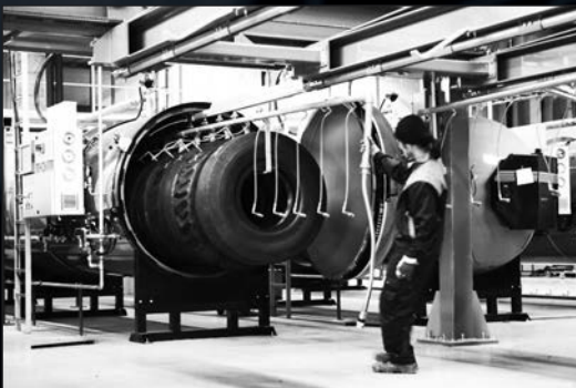
PAISTO (vulkanointi) Renkaat paistetaan paistokammiassa. Optimoitu paine, lämpötila ja aika takaavat laadukkaan lopputuotteen.
