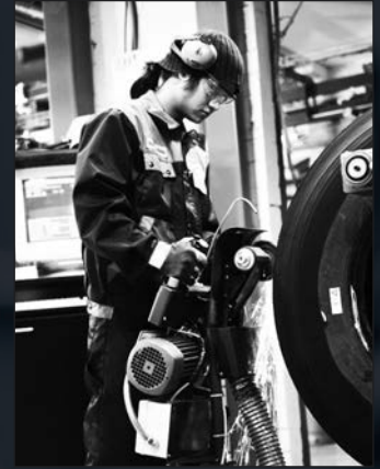
KOLOJEN AUKAISU Mahdolliset renkaan vauriot käydään läpi tarkkaan ja korjataan huolellisesti.
