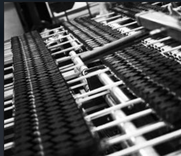
PINTOJEN LEIKKAUS Uusi kulutuspinta leikataan määrämittaan.
