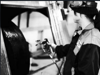
KORJAUS JA LIIMAUS Rungot liimataan kasausta varten.
